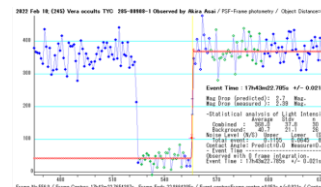
図 8: 図7のシミュレーションモデルにフィットさせて現象時刻最確値を求める図3のビデオの解析を行い、現象時刻として 17^{\text{h}}43^{\text{m}}22.785 \pm 0.021\text{s} が得られた。濃い星像が現れたフレームのタイムスタンプの 17^{\text{h}}43^{\text{m}}22.866\text{s} よりも、0.081s前に現象が起きたことになる。
